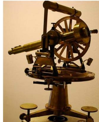
Gambar 3. Theodolite pada abad ke 19
