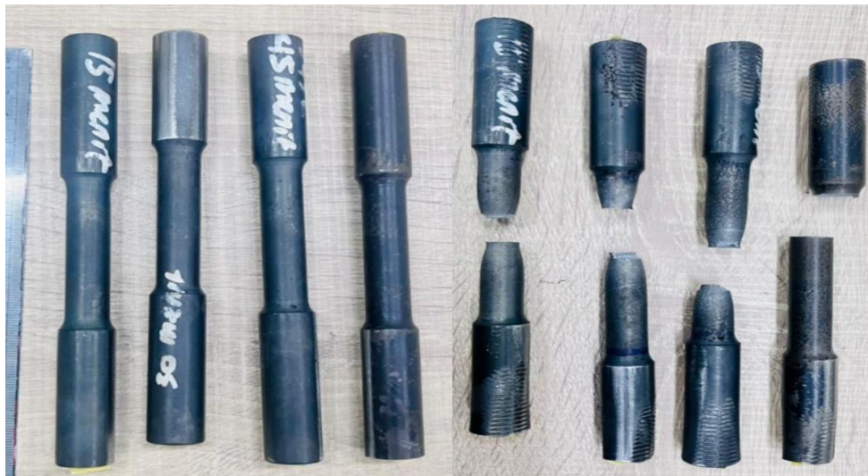
Gambar 4.2 Sampel sebelum dan sesudah dilakukan uji tarik
