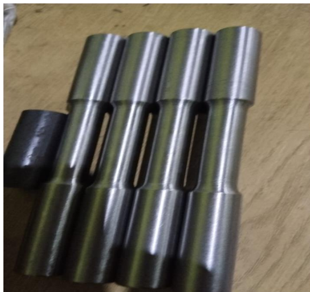
Gambar 3.8 Material S45C dibentuk sesuai standar ASTM E8
