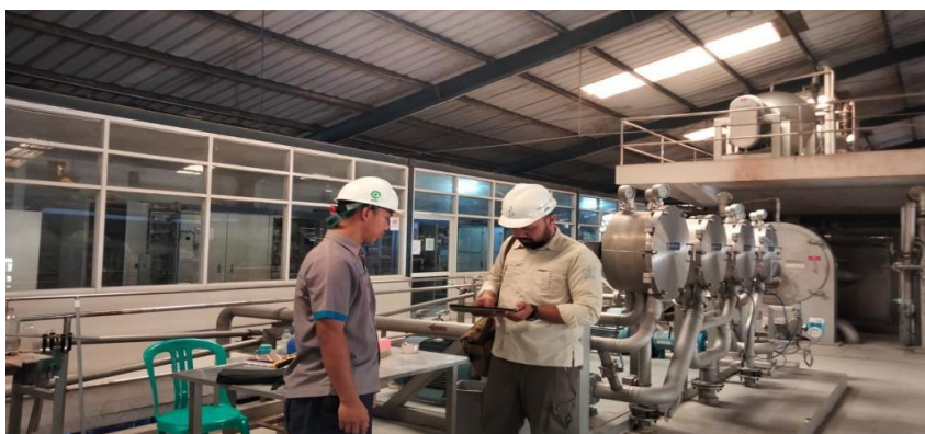
Gambar 1. Proses Hydro Cyclone (Pemisahan untuk meningkatkan sari pati tapioca)
